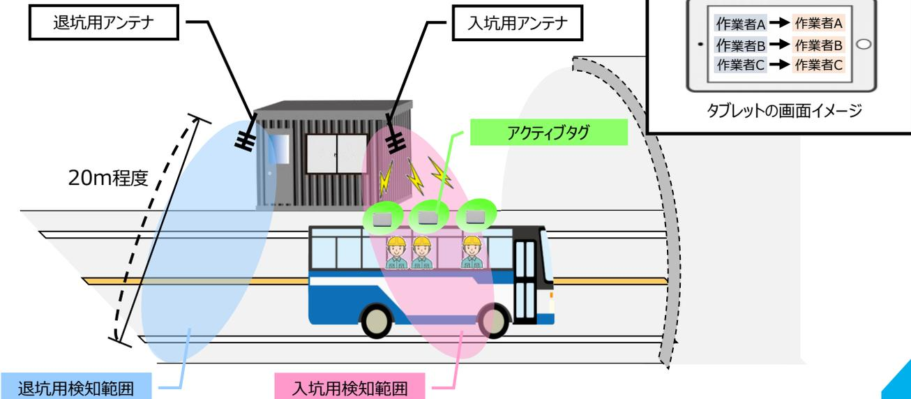
※車両の通過速度が速いと検知出来ない恐れがあるため、車両通過時は低速での通過、もしくは一時停止が必要です。
